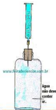
Fig. 1- Determinação da dilatação volumétrica - Uma seringa de injeção é adaptada ao recipiente contendo o líquido em estudo.
